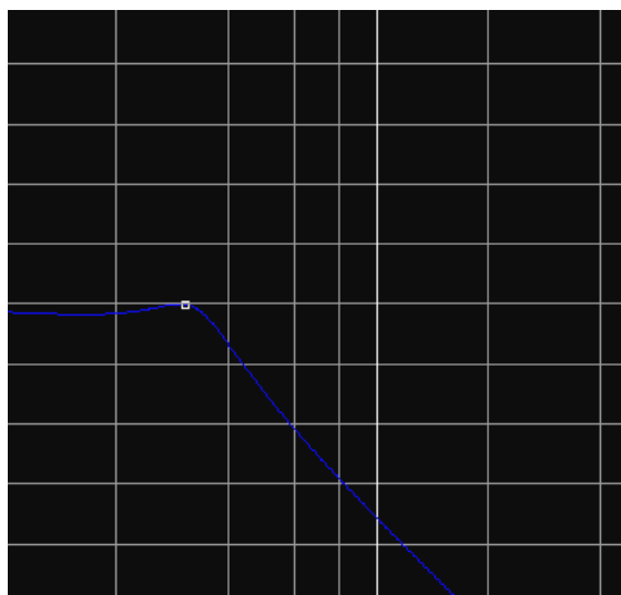
Bild 6: Übertragungsfunktion eines LCL-Filters in logarithmischer Darstellung bei niederohmiger Belastung
